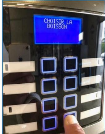
La machine est prête appuyez quelques secondes sur la touche en bas à droite
