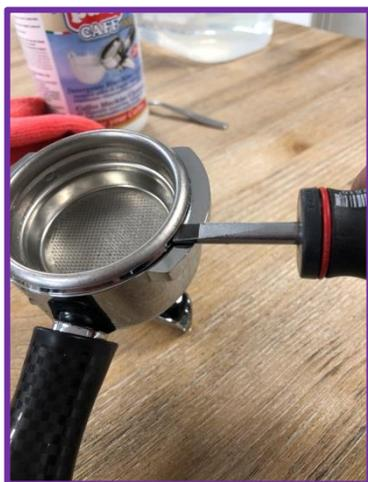
A l'aide d'un tournevis déclipser les filtres
