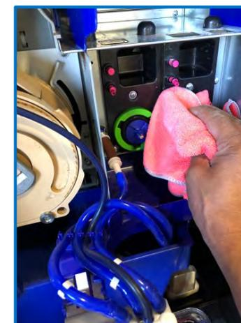
Séchez les turbines avec un chiffon propre
