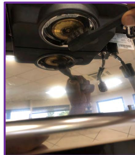
Frotter avec la brosse métallique sous le groupe, la partie en laiton. Ne pas frotter le joint
