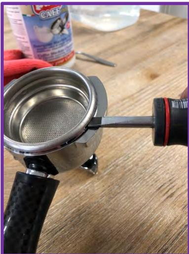
A L'AIDE D'UN TOURNEVIS D'ÉCLIPSEZ LES FILTRES
