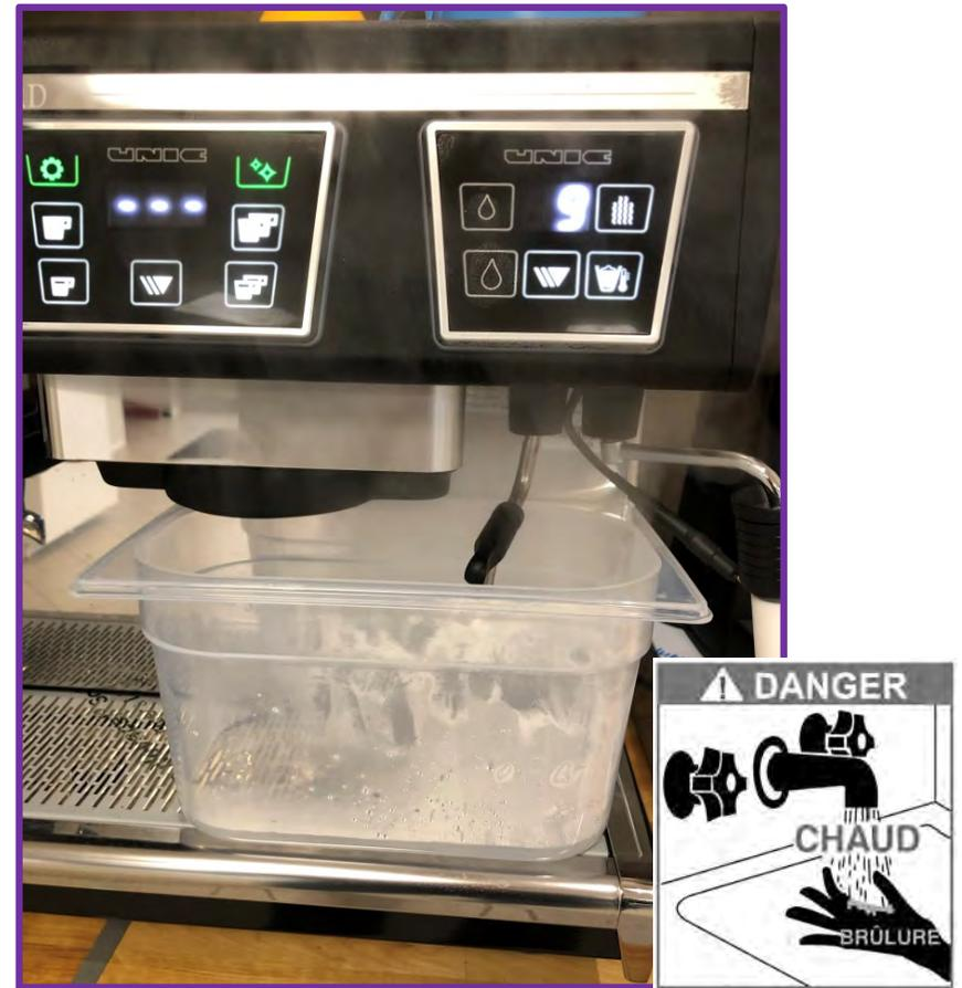
Mettre un récipient sous la sortie eau chaude et tirer 2 litres d'eau chaude, vider le bac, attendre que le manomètre indique la bonne valeur et recommencer
